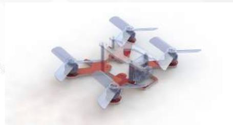
Fig. 8. Ensamble final del sistema RPA con el chasis modificado por medio de la optimización topológica.
